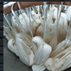
18. 상조(上槽) - 압착 다이진조급이나 이런 전통적인 방법을 아직도 사용하나, 보통은 대용량의 압착기를 사용한다.
